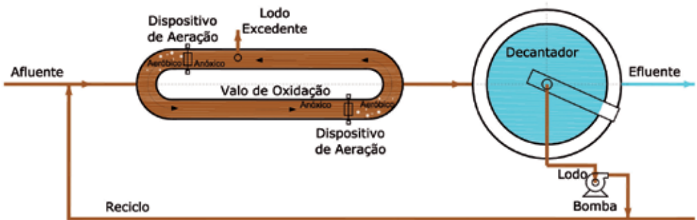
FIGURA 12.18 Valo de Oxidação
