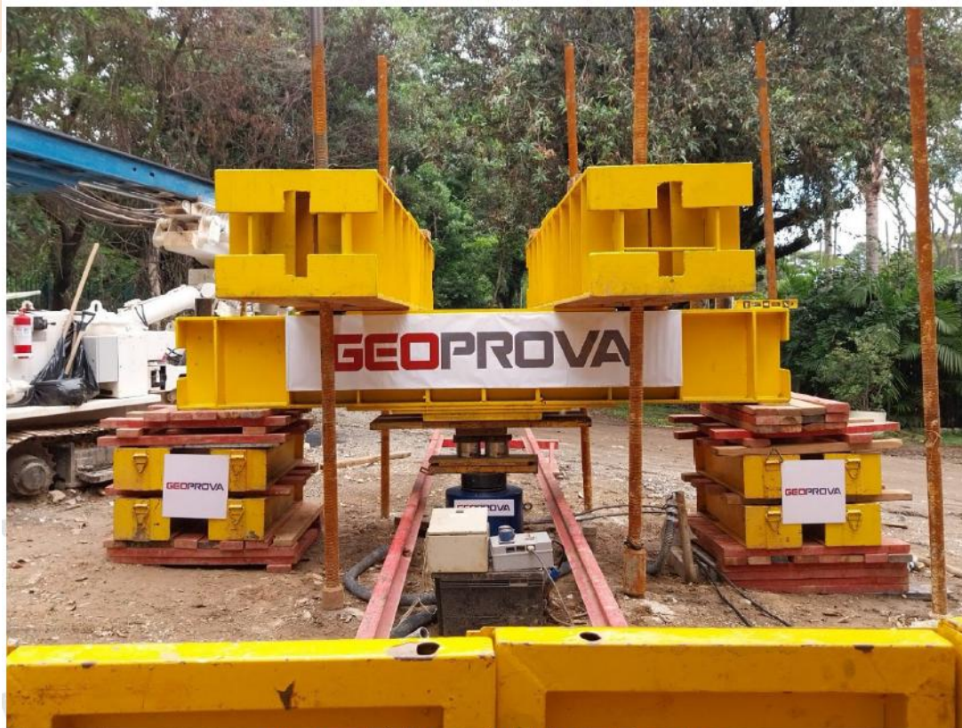
Foto 1: Esquema de montagem da prova de carga estática PCP.01
