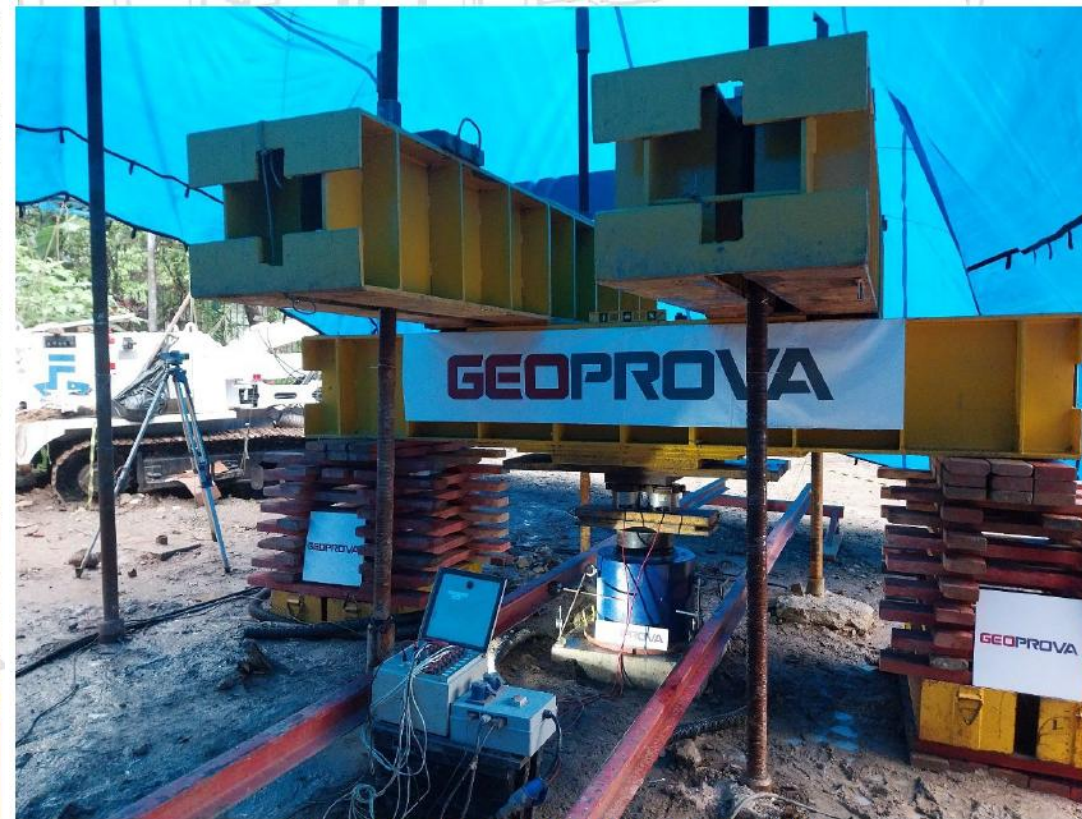
Foto 4: Esquema de montagem da prova de carga estática PCP.02
