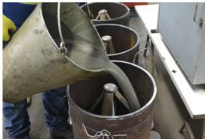
Foto 6 – Vista da etapa de preenchimento com calda de cimento para formação de um dos três corpos de prova.
