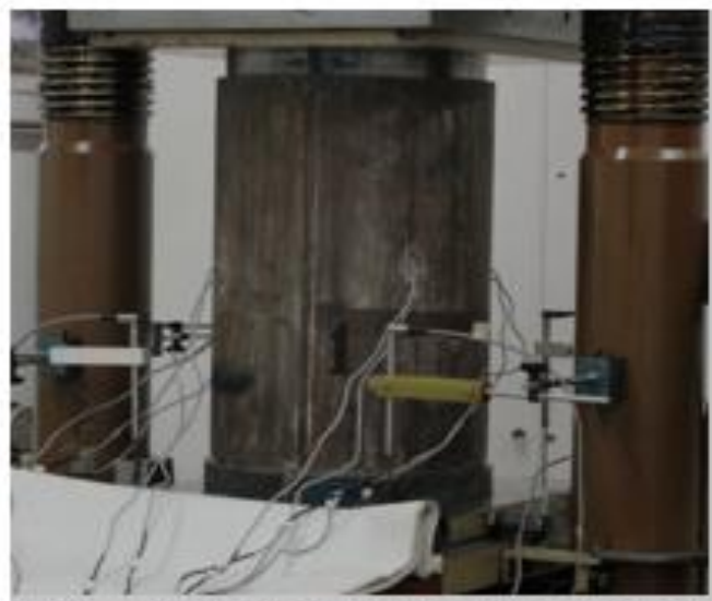
Foto 8 – Detalhe do corpo de prova posicionado entre os pratos da máquina universal de ensaios. No primeiro plano observa-se a fixação dos strain gages e os extensômetros tipo LVDT.
