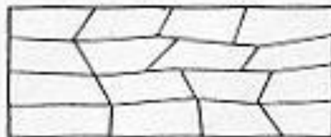
Estrutura no estado laminado a frio
