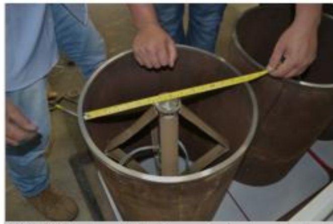
Foto 5 – Vista do conjunto haste e centralizador no interior do tubo de revestimento.
