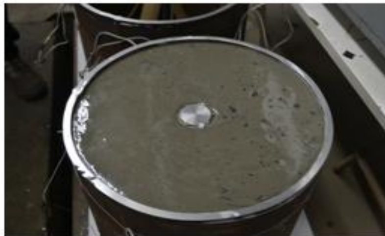
Foto 7 – Vista de topo do corpo de prova recém preenchido com calda de cimento.
