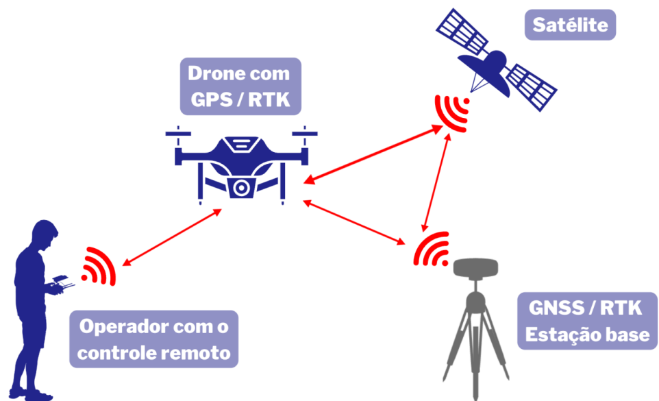
Figura 1: Simplificação da conexão para posicionamento geoespacial dos drones e sua comunicação para processamento RTK. Adaptado de [3]
