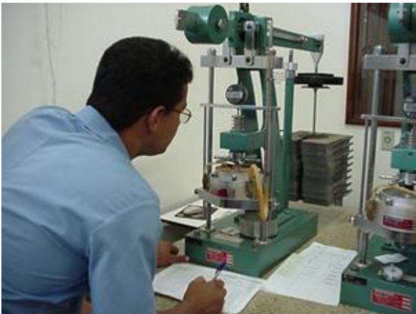
Figuras 36 e 37: Prensa para realização do ensaio de módulo edométrico e exemplo de gráfico com o comportamento quanto a redução de vazios ao longo do tempo.
