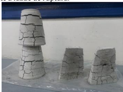
Figuras 33, 34 e 35: Amostras de graute bicomponente que ficaram expostas no ambiente do laboratório, com e sem cura úmida. Fora da câmara úmida a retração por secagem danifica completamente o corpo de prova (arquivo pessoal).
