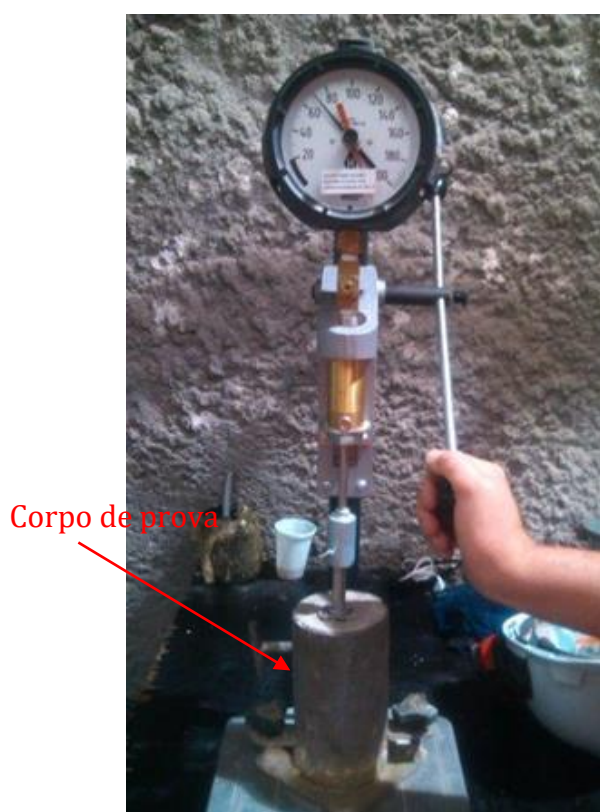
Figuras 27 e 28: Ensaio de resistência nas primeiras idades com o auxílio de penetrômetro (RIVERA et all, 2014) e com a prensa de CBR (RIVERA, 2019).
