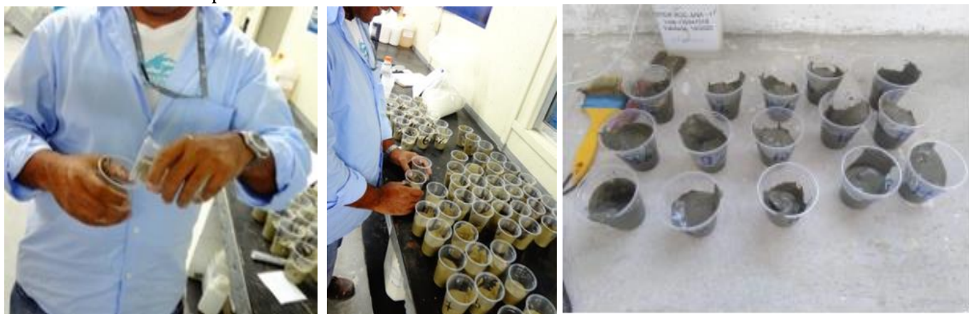
Figuras 17,18 e 19: Mistura e preparo de amostras para ensaios de “gel time” (RIVERA et al, 2014).
