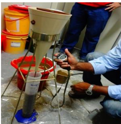
Figura 14: Avaliação da fluidez e vida útil do Componente A utilizando cone de Marshal para calda (RIVERA et all, 2014).
