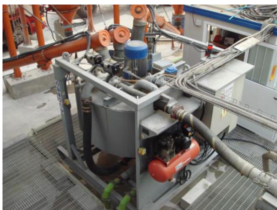
Figuras 9 e 10: Turbomixer e agitador projetado pela Seli e fabricados pela Innotek Itália para a Linha 4 Amarela do Metrô de São Paulo (PELLEGRINI, 2009).
