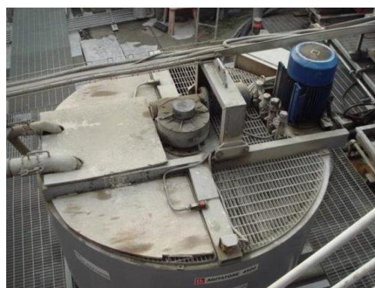
Figuras 9 e 10: Turbomixer e agitador projetado pela Seli e fabricados pela Innotek Itália para a Linha 4 Amarela do Metrô de São Paulo (PELLEGRINI, 2009).
