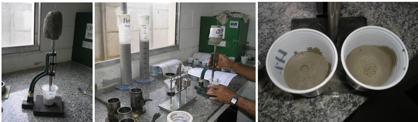
Figuras 24,25 e 26 - Ensaio de resistência na idade de 1 hora. A resistência de 0,1 MPa foi considerada quando a sondada agulha de Vicat não penetrava no graute endurecido (arquivo pessoal).
