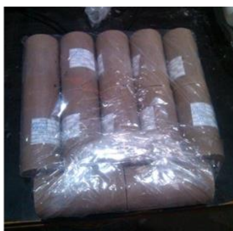
Figuras 31 e 32: Preparo a acondicionamento de corpos de prova para transporte e armazenamento (RIVERA et all, 2014).
