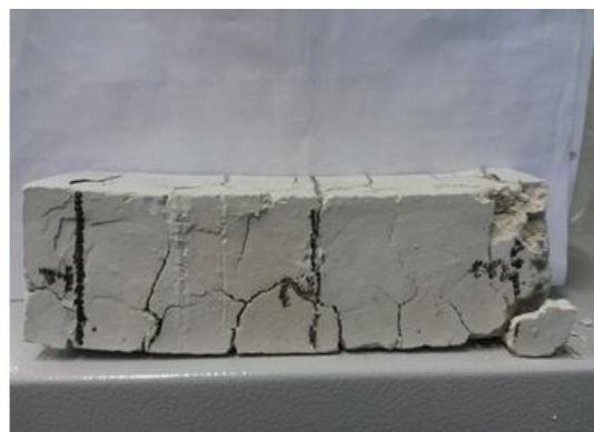
Figuras 33, 34 e 35: Amostras de graute bicomponente que ficaram expostas no ambiente do laboratório, com e sem cura úmida. Fora da câmara úmida a retração por secagem danifica completamente o corpo de prova (arquivo pessoal).
