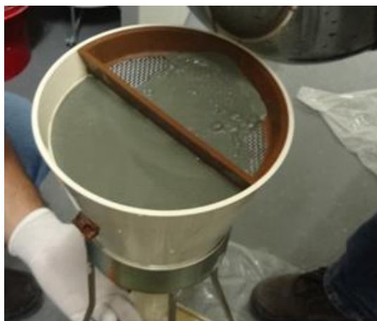
Figuras 7 e 8: Componente A após mistura realizada em laboratório e detalhe do material retido na peneira indicando necessidade de nova homogeneização (RIVERA et al, 2014).
