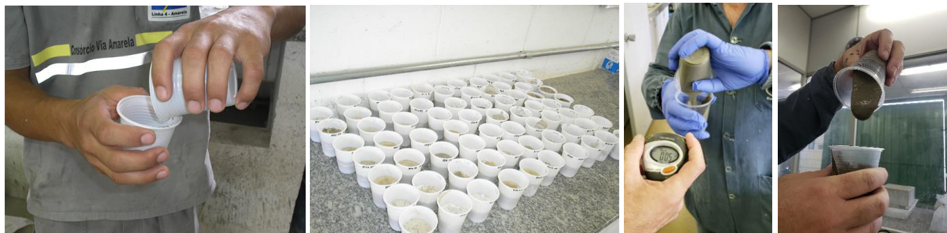
Figuras 20,21 e 22 - Ensaio de “gel time”, ficou conhecido como teste do copinho (arquivo pessoal)
