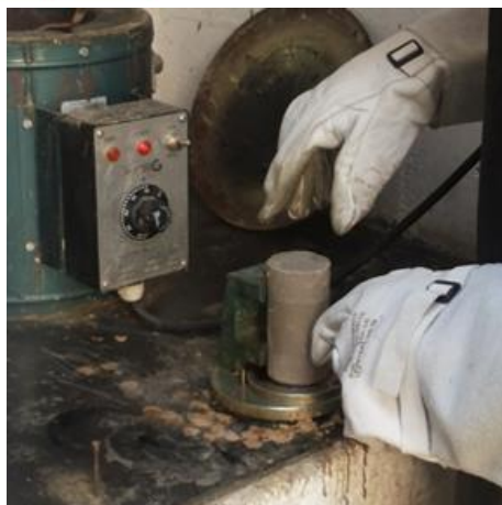
Figuras 29 e 30: Capeamento dos tops do corpo de prova e realização de ensaio de resistência à compressão em prensa hidráulica com célula de carga (RIVERA et all, 2014).
