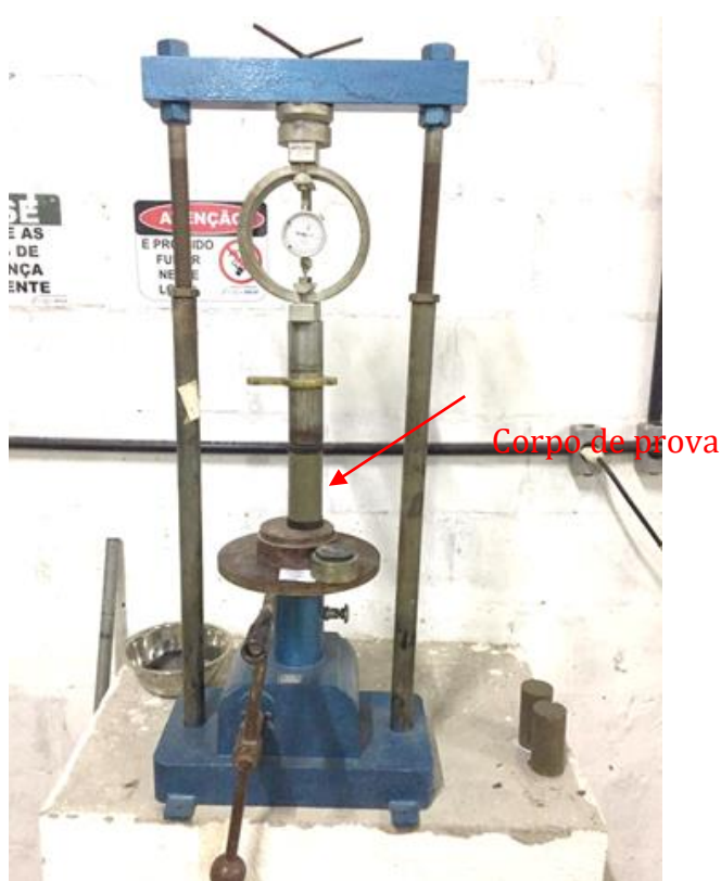
Figuras 27 e 28: Ensaio de resistência nas primeiras idades com o auxílio de penetrômetro (RIVERA et all, 2014) e com a prensa de CBR (RIVERA, 2019).
