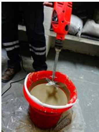
Figuras 7 e 8: Componente A após mistura realizada em laboratório e detalhe do material retido na peneira indicando necessidade de nova homogeneização (RIVERA et al, 2014).
