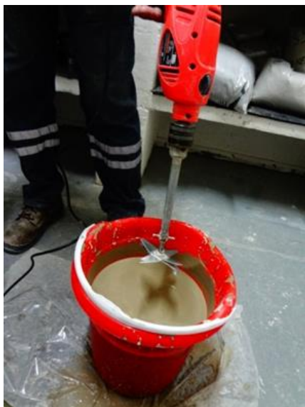
Figuras 07 e 08: Mistura de calda de bentonita e água e ensaio de fluidez (RIVERA ET ALL, 2019).
