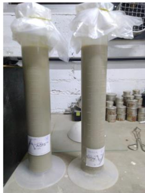
Figuras 09 e 10: Ensaio de exsudação e densidade da calda (arquivo pessoal).
