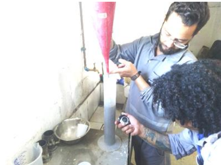
Figuras 07 e 08: Mistura de calda de bentonita e água e ensaio de fluidez (RIVERA ET ALL, 2019).
