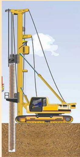
(a) introdução do trado (b) concretagem sem rodar o trado (c) introdução da armadura (cuidado no início da concretagem!!!!!! – slide 33)
