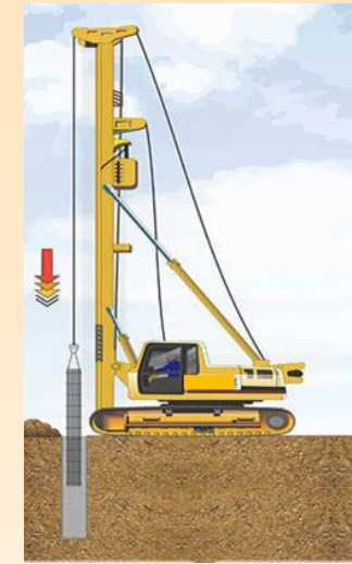
(a) introdução do trado (b) concretagem sem rodar o trado (c) introdução da armadura (cuidado no início da concretagem!!!!!! – slide 33)
