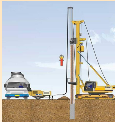
(a) introdução do trado (b) concretagem sem rodar o trado (c) introdução da armadura (cuidado no início da concretagem!!!!!! – slide 33)
