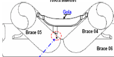
Extremidade inferior da Trinca 3 no brace 05
