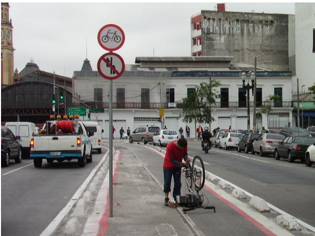
Poste na faixa de rolamento das bicicletas
