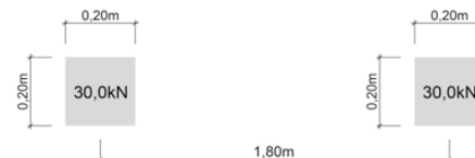
Figura 6.2 – Eixo-tipo simples para verificação de cargas concentradas – Categoria II
