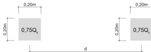
Figura 6.10 – Cargas concentradas para projeto de helipontos
