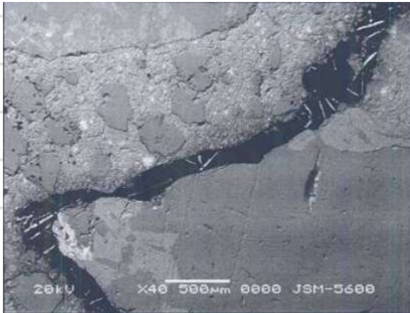
Cristais formados na fissura
