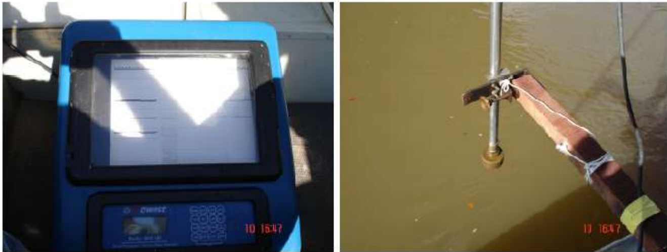
Sonda acústica e transdutor
