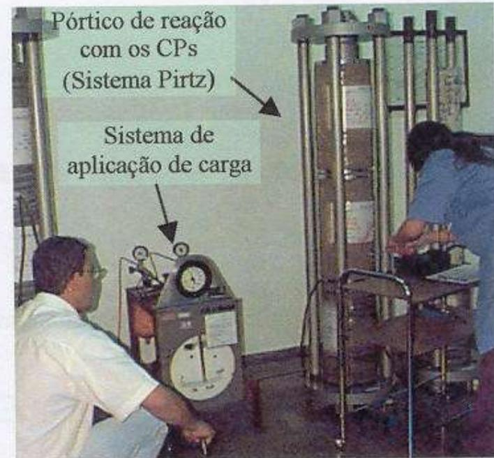
(b) Aplicação de carga – ensaio de fluência
