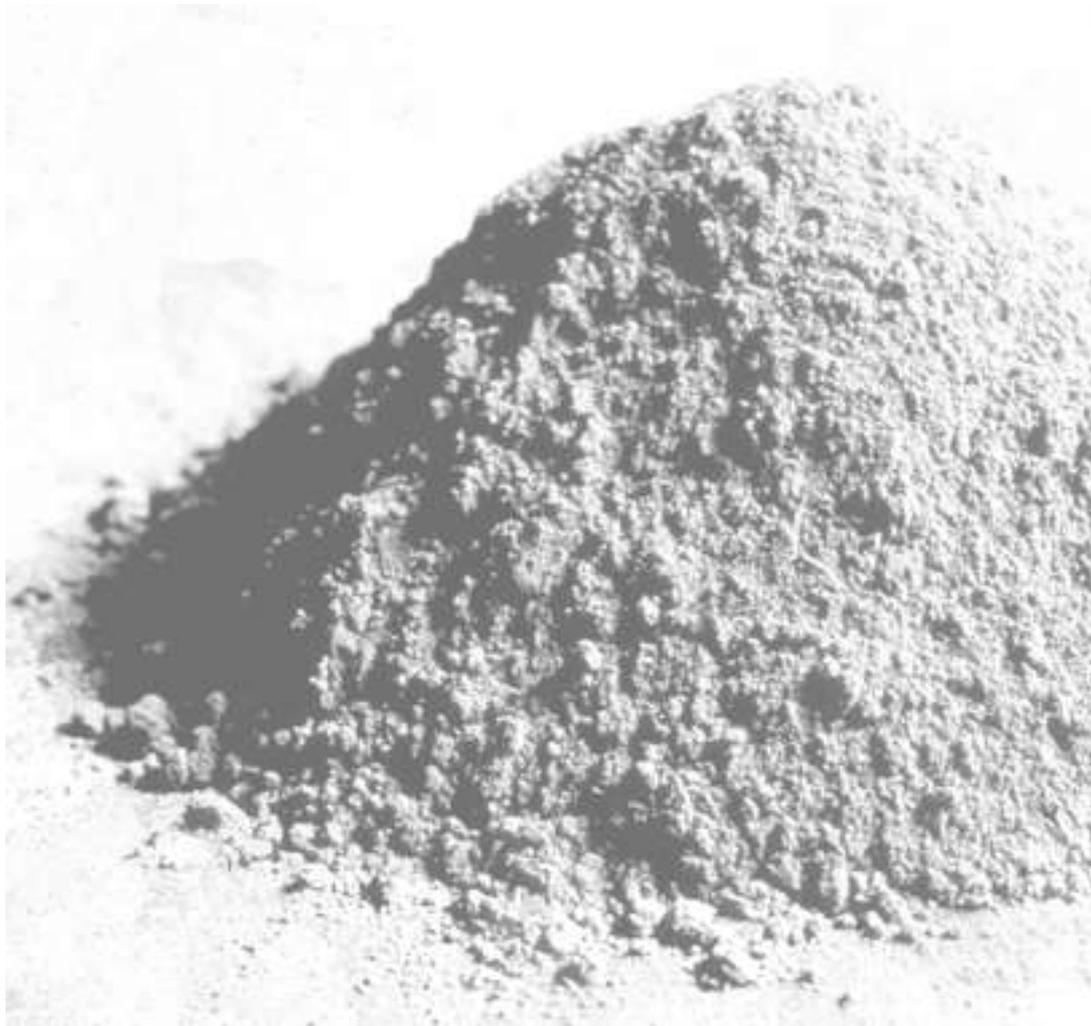
Uma mistura de componentes ativos em pó que reagem com a umidade do concreto para catalisar uma estrutura cristalina insolúvel. Os milhões de cristais formados penetram profundamente no concreto, selando os poros, capilares e fissuras de retração da penetração de água.
